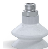
Referência da variação: 8A 44SLT M14 • Cor: Translúcido com certificação CE para contato com alimentos • Dureza da costa: SH60 • Matéria: Silicone
